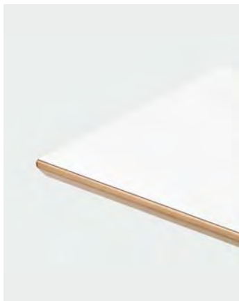
Kante I Tischplatte 20 oder 30 mm stark, Stirnseite Buchen-Massivholz-Anleimer 30/5 mm oben und unten mit Fase, Längsseite Buchen-Massivholz-Anleimer nach unten abgeschrägt
