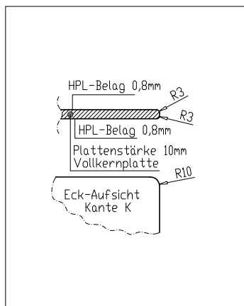
Kante K Tischplatte 10 mm stark, Vollkernplatte Radius oben und unten 3 mm
