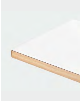
Kante C Tischplatte 30 mm stark, mit 5 mm Massivholz-Einleimer, R oben und unten 3 mm
